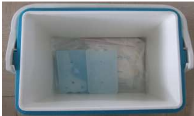
Fig. 5 – Contentor de transporte com acumuladores de frio.
