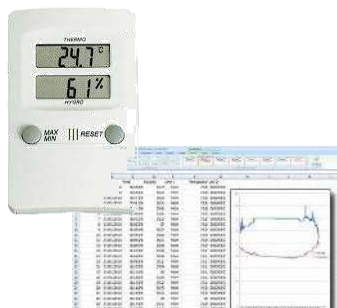
Figura 3. Termo-higrómetro e respetivo registo automático em suporte informático
